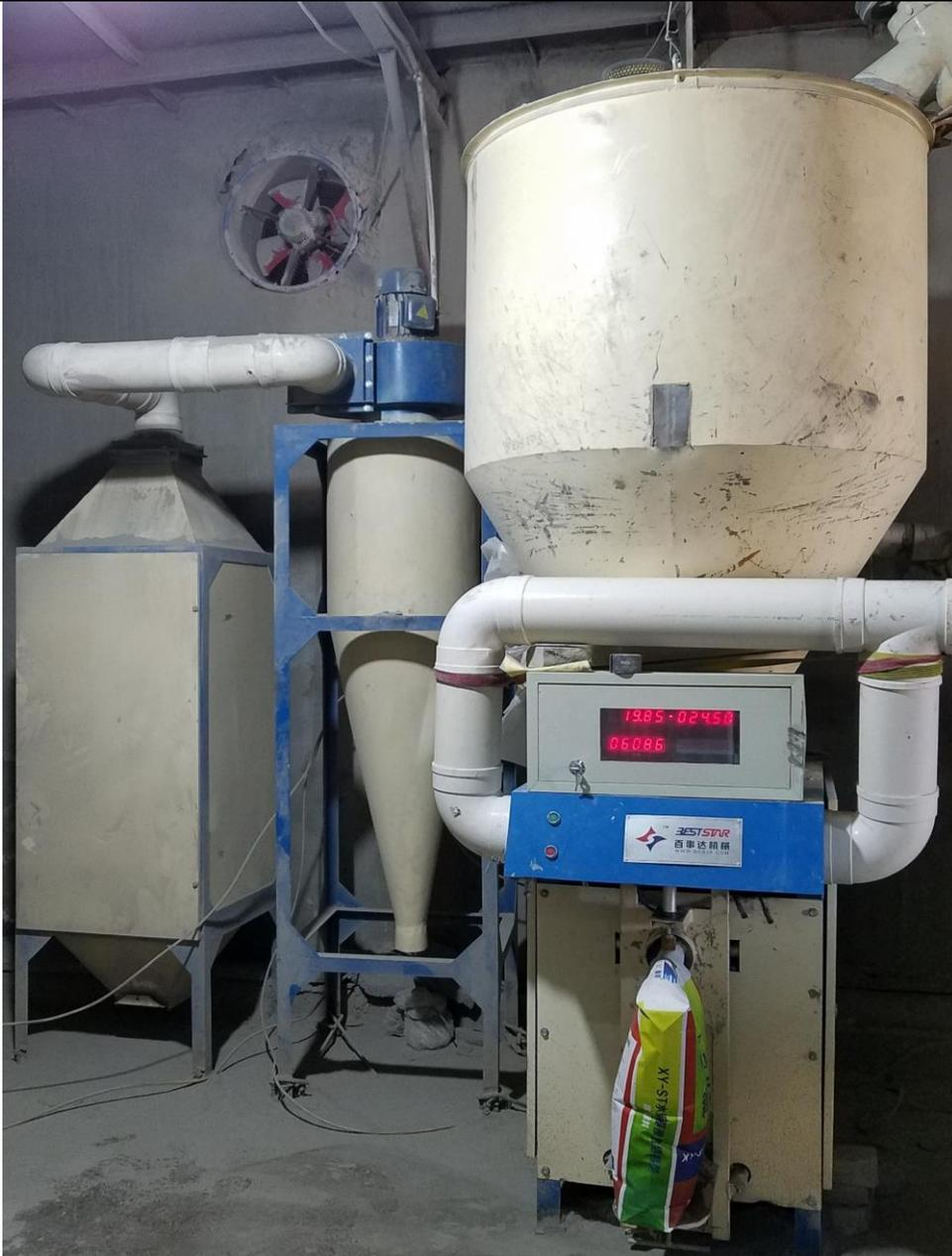
图9 TH-50 干粉砂浆机配带的 TH-30-60CC 布袋除尘器图
