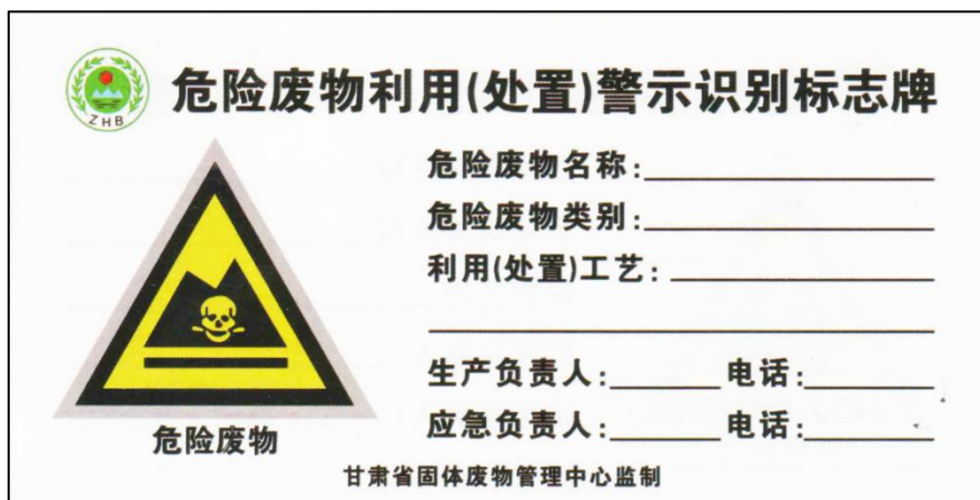
图6-4 项目危险废物利用（处置）点警示标示标志牌
